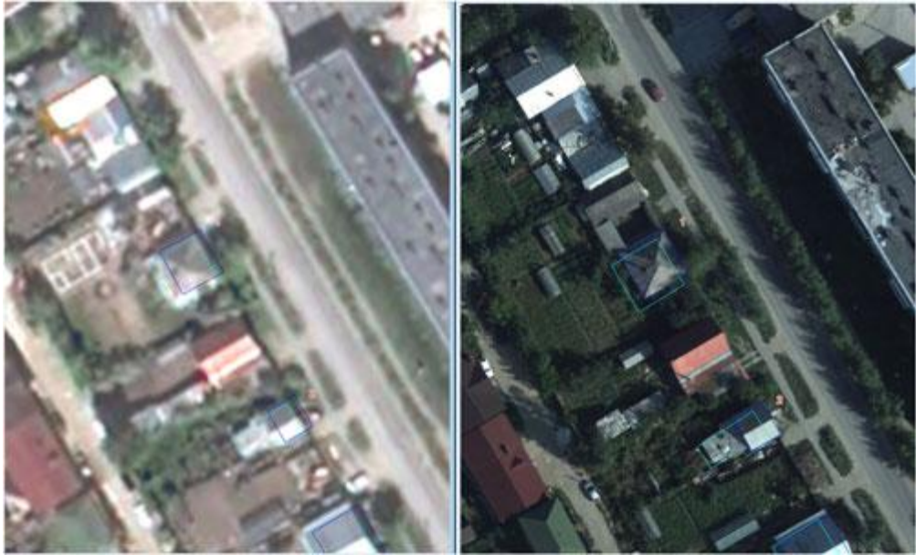
Рисунок 2. Размеры здания неверные (ширина здания 9 м по АФС и 10 м по КС) (1); по КС невозможно отделить жилую постройку от нежилой (2)
