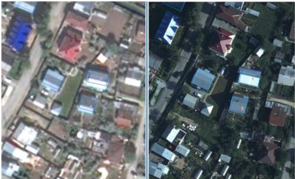
Рисунок 3. Не отображен уступ шириной 1.5 м (1), форма и размер здания отображены с ошибкой 2 м (2)
