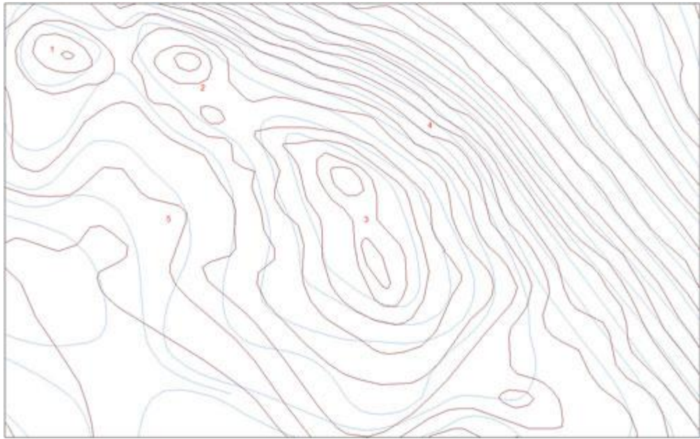
Рисунок 8. Сравнение горизонталей: коричневым цветом — созданы по аэроснимкам, синим цветом — созданы по КС Pleiades. Пропущены горки высотой до 3-4 м (1), (2), (3), не отображен лог (4), (5)
